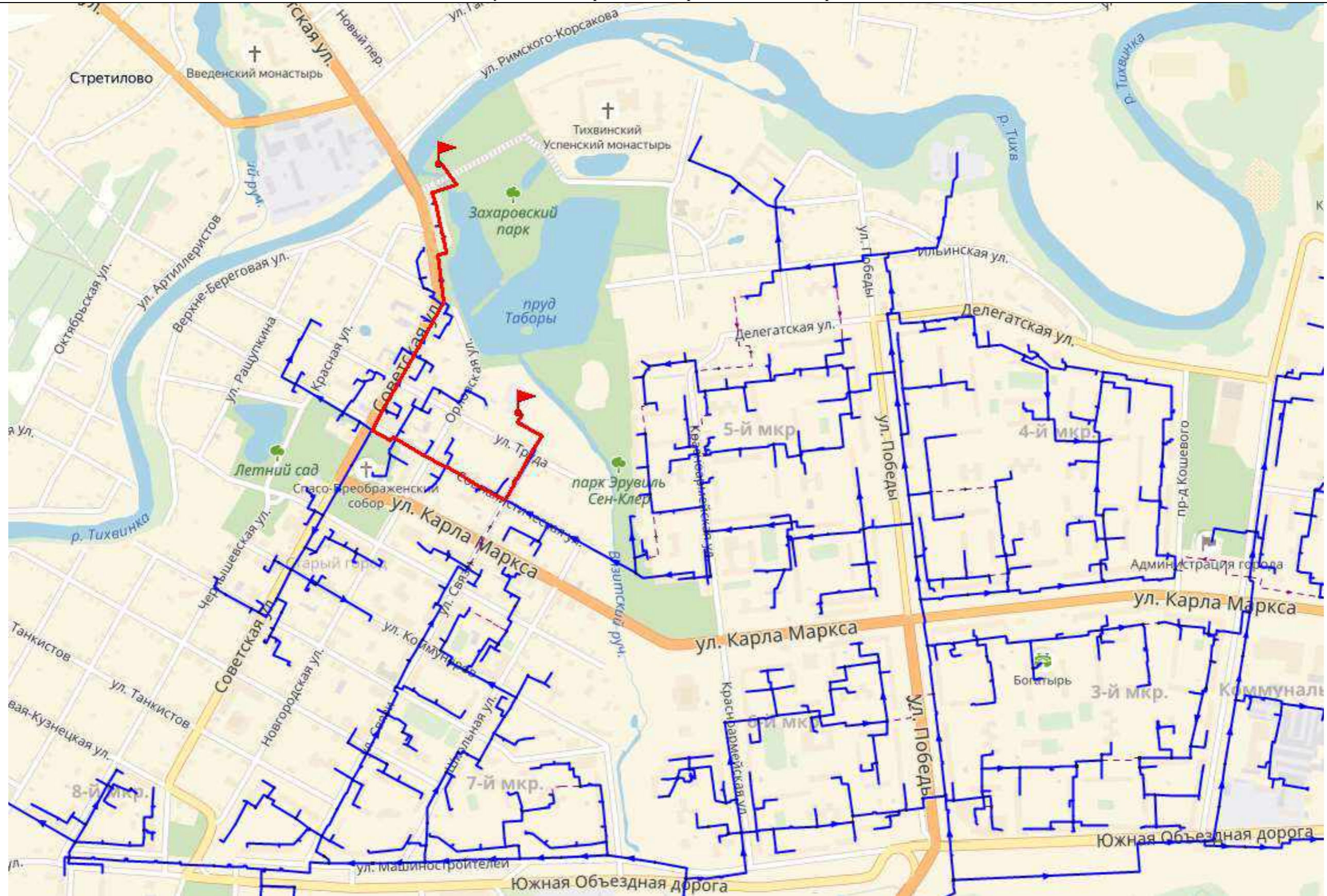
Рисунок 28. Путь построения пьезометрического графика от ЦТП «Старый город» до Тихвинская ул. , 3
